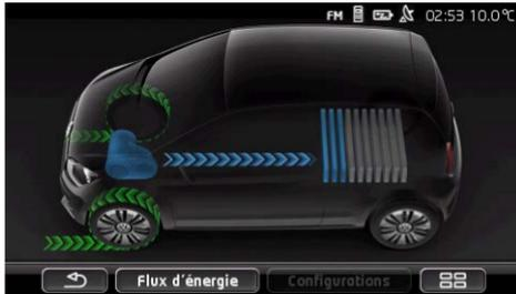
Le véhicule est en roue libre et le véhicule est freiné par le conducteur
