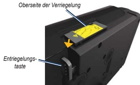
**ACHTUNG:** Vergewissern Sie sich vor dem Losfahren, dass die Oberseite der Verriegelung flach ist und das Gerät sicher befestigt ist.
