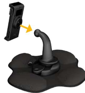
6. Setzen Sie die Unterseite des Navigator IV in die Halterung ein.
