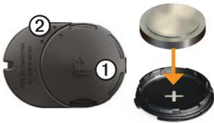
1. Repérez le cache circulaire du compartiment à pile ① à l'arrière du chirp™.
