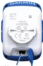
Mini-USB-poort onder beschermkap
