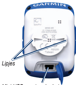
Mini-USB-poort onder het beschermkapje
