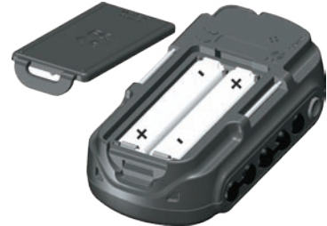
Installation de piles AAA dans le Foretrex 101
