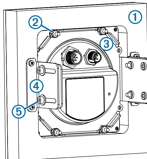
2 Postavite vijke za maticu ② u četiri rupe za montažu sa stražnje strane uređaja.
