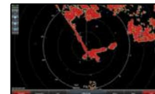
Die MotionScope™-Technologie nutzt den Doppler-Effekt, um Bewegungsrichtungen der Ziele zu erkennen und so mögliche Kollisionen zu verhindern.
