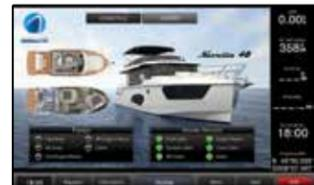
EmpirBus™ Systeme verfügen über vollständig anpassbare Layouts und Grafiken, mit denen jeder Schalter oder Monitor in jeder Konfiguration mit einem einfachen Programm erstellt werden kann. Hintergründe können durch Hochladen von Bootsbildern individualisiert werden.
