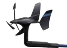
Eine installationsfreundliche Lösung, die das Durchführen von Kabeln bei Masten von bis zu 15 Metern überflüssig macht. Genaue Windsignale werden über eine ANT®-Verbindung direkt an ein GNX Wind-Instrument oder einen kompatiblen Kartenplotter der Garmin GPSMAP-Serie<sup>1</sup> gesendet. Das montierte Solarpanel versorgt die interne Batterie mit Strom. Die Batterie hält drei Jahre und kann leicht ausgetauscht werden.
