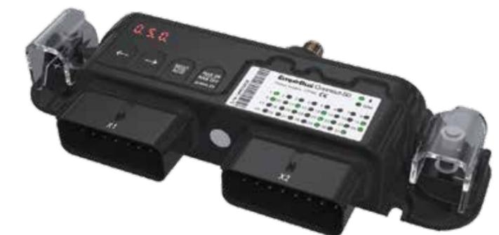
Reverse-Polarität bei zwei Kanälen zur Steuerung von Antrieben, Fenstern, Luken, etc. sowie die Möglichkeit der Steuerung und Synchronisierung der Scheibenwischer ist standardmäßig vorhanden.
