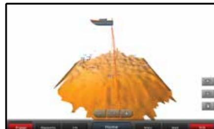
Scannt den Bereich unter dem Boot: von vorn nach hinten und von einer Seite zur anderen. Dadurch kann es dir eine 3D-Komplettansicht des Bereiches unterhalb des Bootes liefern. Du siehst Bodenveränderungen sowie Fische und Strukturen, selbst wenn das Boot nicht fährt.
