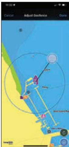
Erfahre als Erster, wenn ein Sicherheitssensor ausgelöst oder dein Boot bewegt wurde. Der interne GPS-Sensor wird je nach Leistungsstatus alle 15 oder 30 Minuten aktualisiert und sendet Text-Alarme<sup>1</sup>, wenn dein Boot den per Geofencing begrenzten Bereich verlässt.
