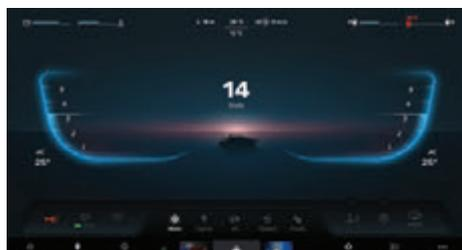
EmpirBus™ Systeme verfügen über vollständig anpassbare Layouts und Grafiken, mit denen jeder Schalter oder Monitor in jeder Konfiguration mit einem einfachen Programm erstellt werden kann. Hintergründe können durch Hochladen von Bootsbildern individualisiert werden.
