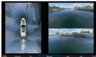
Der 360 °-Videofeed wird auf kompatiblen Garmin Kartenplotttern oder MFDs angezeigt. Jede Kameraansicht kann auch einzeln angezeigt werden.
