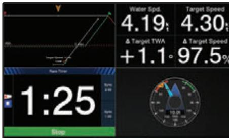
Mithilfe der Polartabellen berechnet der Kartenplotter den optimalen Windwinkel für die höchstmögliche Geschwindigkeit, die zu diesem Zeitpunkt auf dem Segelboot möglich ist. Diese Informationen helfen dir, um deine Segel optimal zu trimmen.
