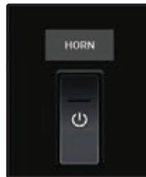
Steuere Signalhörner und mehr. Du kannst die gewünschte Dauer des Signaltons durch längeres oder kürzeres Gedrückthalten der Taste bestimmen.
