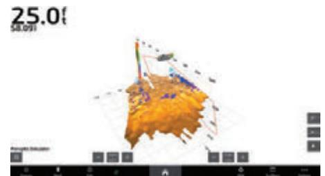
Scannt den Bereich unter dem Boot: von vorn nach hinten und von einer Seite zur anderen. Dadurch kann es dir eine 3D-Komplettansicht des Bereiches unterhalb des Bootes liefern. Du siehst Bodenveränderungen sowie Fische und Strukturen, selbst wenn das Boot nicht fährt.
