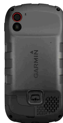
Rückansicht des Garmin Monterra mit Lautsprecher, Mikrofon, Kamera sowie LED-Blitz-/Taschenlampe
