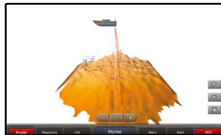
Balaie l'ensemble de la colonne d'eau, d'avant en arrière et affiche en 3D tout ce qui se trouve sous le bateau : profil du fond, structures et poissons – même lorsque vous êtes en position stationnaire.
