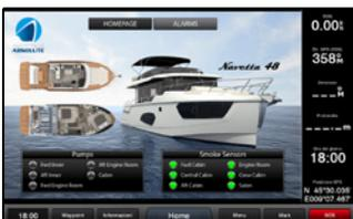
La technologie EmpirBus s'adapte à n'importe quelle configuration électrique. L'interface graphique peut être personnalisée en fonction du nombre de commutateurs avec un logiciel dédié. Les écrans Garmin peuvent également être personnalisés aux couleurs du bateau.
