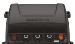
Le module sondeur Ultra-Haute Définition GCV™ 20, permet de profiter des modes ClearVü™ CHIRP et SideVü™ CHIRP sur votre traceur de cartes ou combiné GPS et constitue un excellent outil de prospection pour la pêche sportive.
