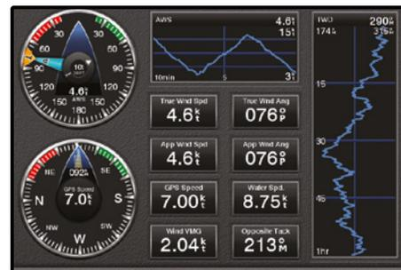
Page vent dédiée avec historiques de la direction et la vitesse du vent réel/apparent.
