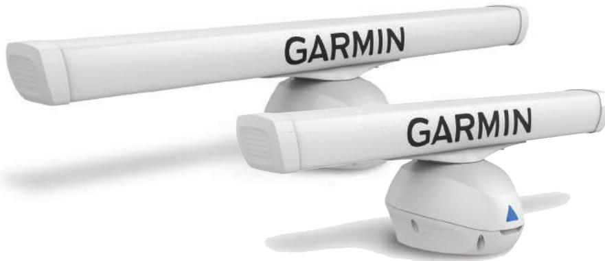
Le GMR Fantom est un radar à semi-conducteur de 40W intégrant la technologie MotionScope™. Cette technologie exclusive utilise l'effet Doppler pour mesurer précisément la vitesse des cibles mouvantes et anticiper les risques de collision.
