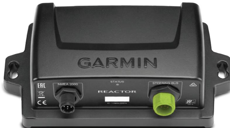
Avec le GHP Reactor, Garmin s'apprête à démocratiser une technologie jusque là réservée aux professionnels du transport maritime. Issue de l'aviation, cette technologie s'adapte aussi bien aux voiliers qu'aux embarcations motorisées et simplifie l'installation et la calibration du pilote. Le nouveau pilote automatique intègre une centrale d'attitude AHRS 9 axes qui calcule la position du bateau en temps réel tout en prenant en compte la giration, le roulis et le tangage.
