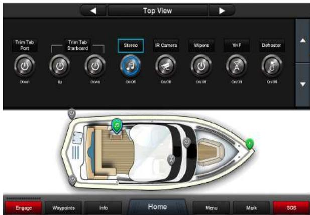
Avec le Digital Switching, contrôlez les différents équipements électriques du bord comme les lumières ou la climatisation, depuis un appareil de la série GPSMAP compatible. Ce système de commutation numérique nécessite l'utilisation d'appareils compatibles externes à Garmin. Vous pouvez gérer l'alimentation de votre bateau, allumer les pompes et contrôler les lumières. Presque tous les contrôles seront accessibles du bout des doigts depuis l'écran multifonction.
